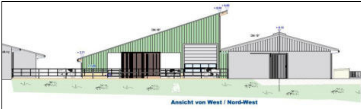
Abbildung 5: Ansicht des geplanten Reprostalls von Westen. Rechts in der Darstellung befindet sich der südliche Teil des Boxenlaufstalls mit Melkbereich (BE 01), links ist der Traufbereich des nördlichen Teils, der Boxenlaufstall zu sehen. Ansichtszeichnung vom 6.6.2020, erstellt durch BILLIGEN INGENIEUR- & PLANUNGSBÜRO in 54552 Dreis-Brück.
