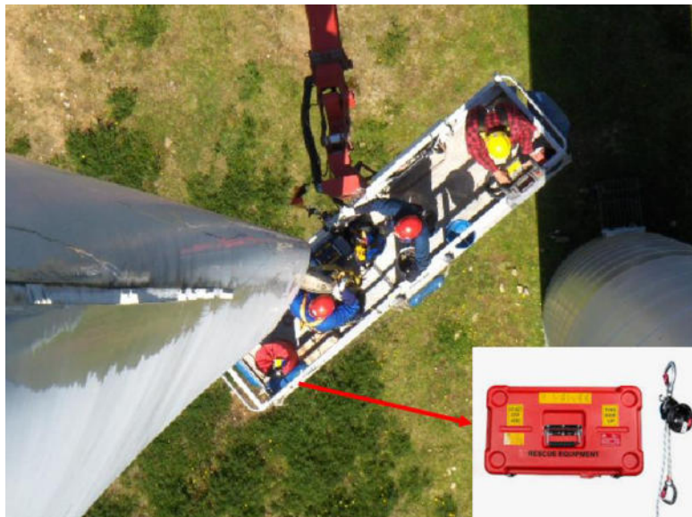
Abbildung 10-1: Beispiel für einen Notabstieg an einem Mannkorb
