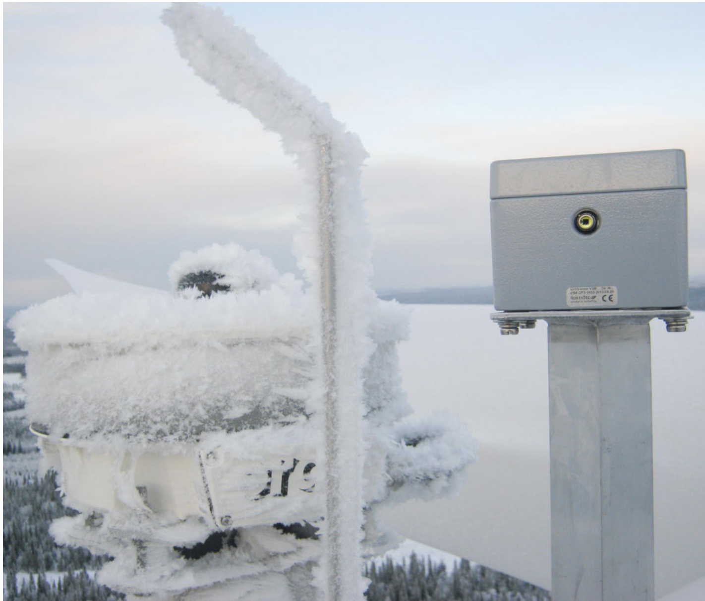
Lichtsensoren-Einheit (beheizt) auf dem Maschinenhaus
