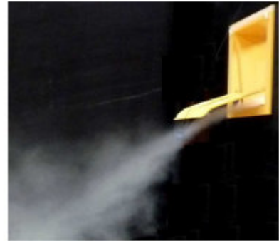
Luftleitung in den Tierbereich
