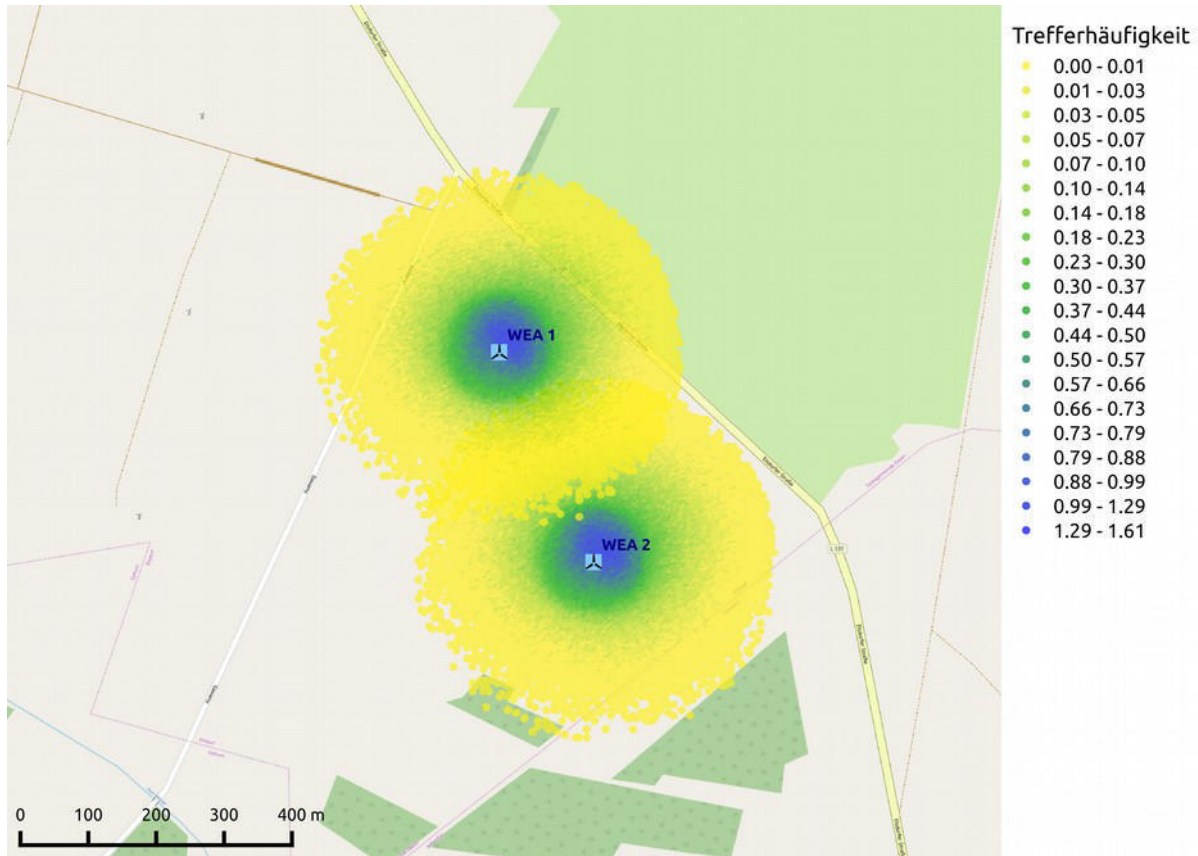
Abbildung B.1.1: Trefferhäufigkeiten von Eisstücken pro Rasterfläche (16m 2 ) und Jahr in der Umgebung der WEA 1 und 2 am Standort Elsdorf III (Karte /1.4/).
