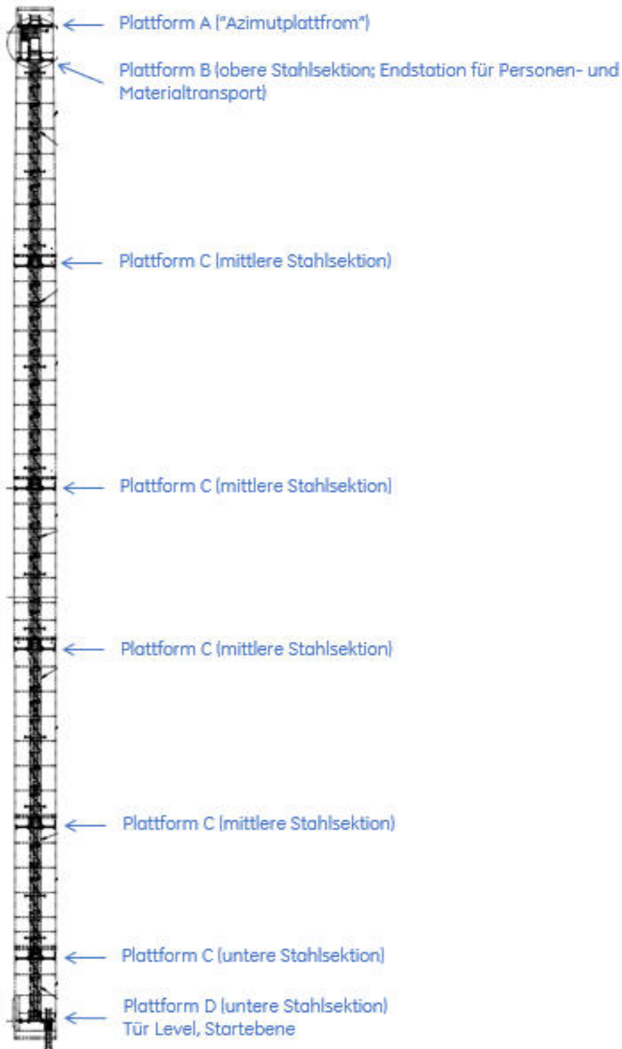
Abbildung 3: Übersicht der Turmplattformen im Stahlrohrturm
