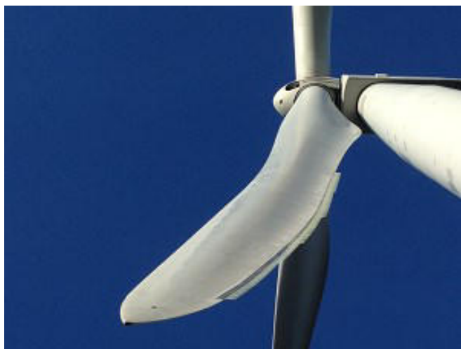
Abb. 1: Serrations (gezackte Blatthinterkanten) an einer WEA
