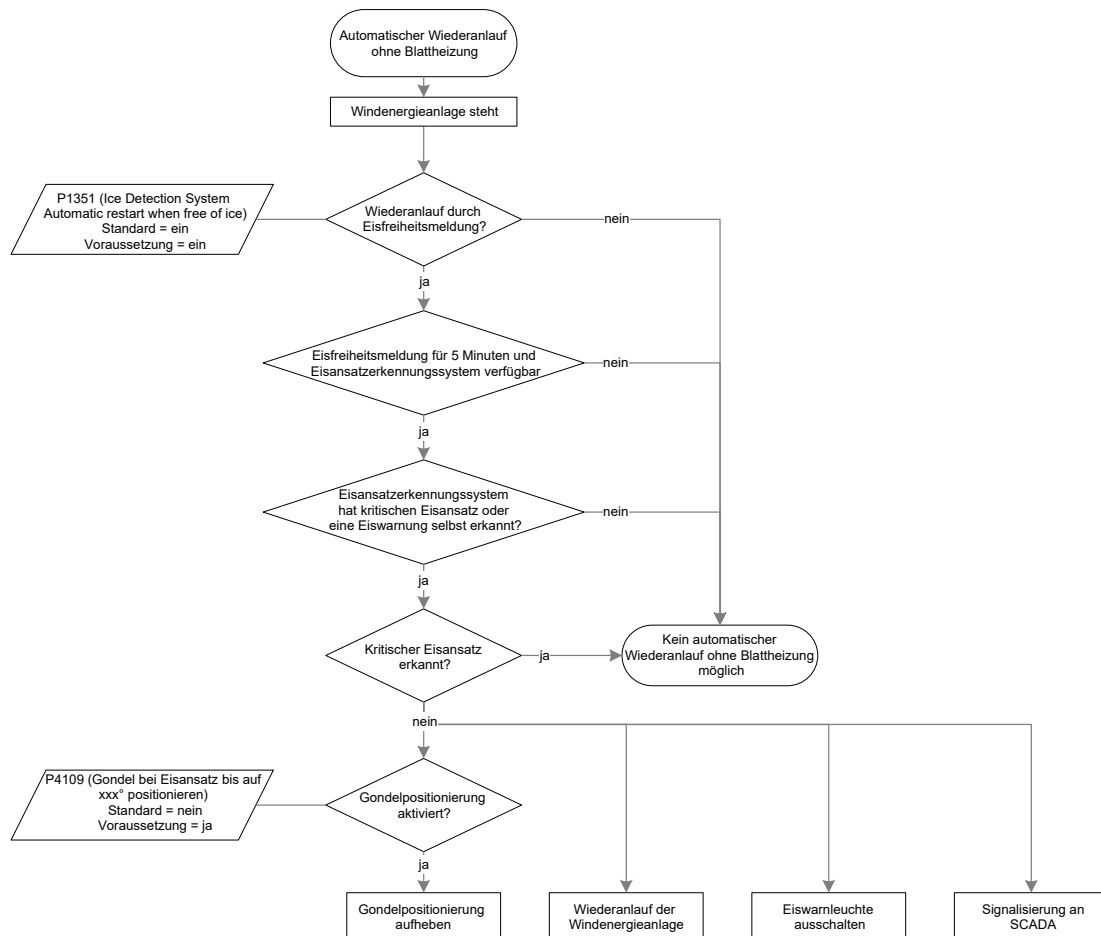
Abb. 8: Automatischer Wiederanlauf ohne Blattheizung
